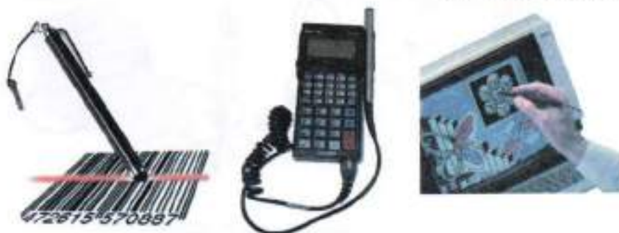
الشكل (2-14) أشكال من القلم الضوئي واستخداماته
