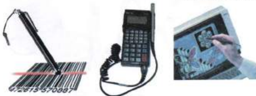
الشكل (2-14) أشكال من القلم الضوئي واستخداماته
