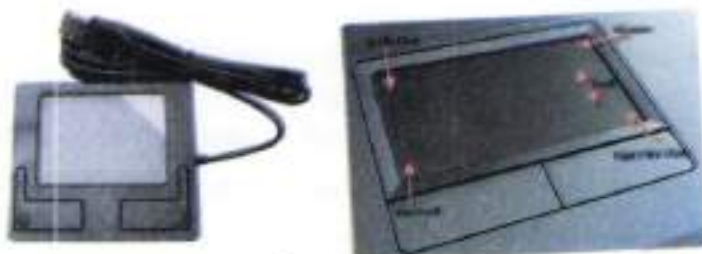
الشكل (2-10) نوعين من لوحة اللمس (ثابتة ومتحركة)
