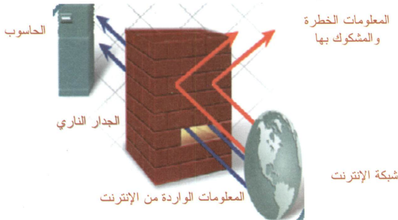
الشكل (3-3) تفعيل عمل الجدار الناري لحجب المعلومات الخطيرة عن الحاسوب
